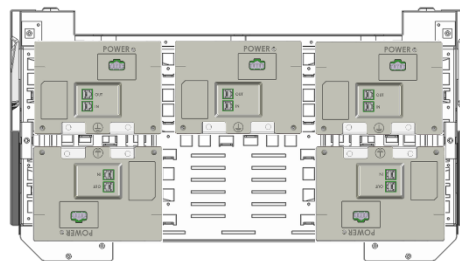
5 modułowych akumulatorów Helios
